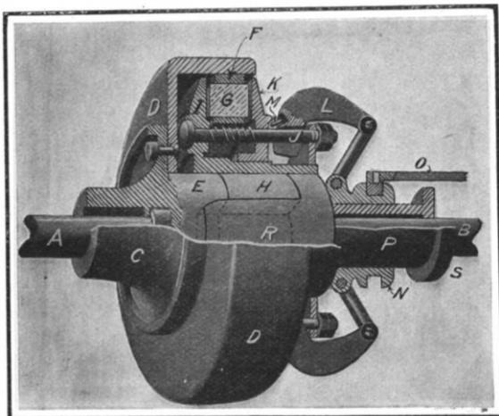
**COMBINED FRICTION AND JAW CLUTCH.**
