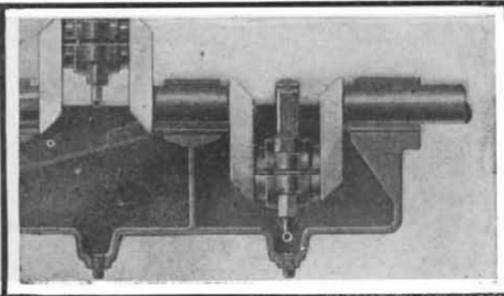
Fig. 7.—CRANKSHAFT LUBRICATION BY THE SCOOP SYSTEM.
