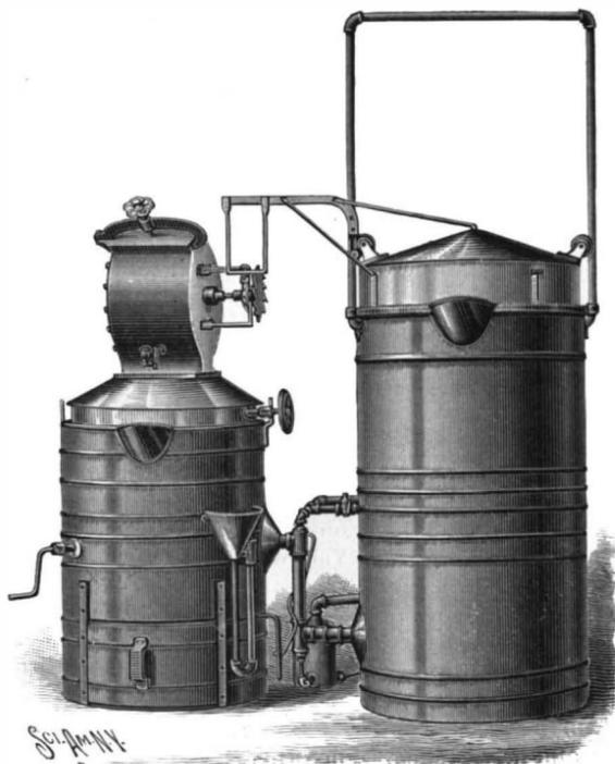
**AN AUTOMATIC ACETYLENE GAS GENERATOR.**
