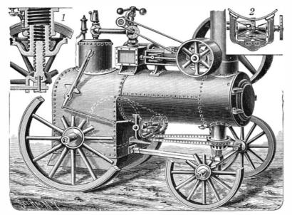
SAXON'S BOILER LEVELING DEVICE FOR ROAD ENGINES.
