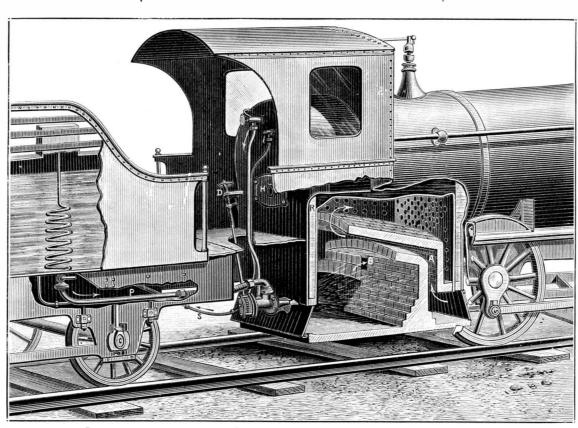
Fig. 1.—ARRANGEMENT OF A LOCOMOTIVE BURNING PETROLEUM.
