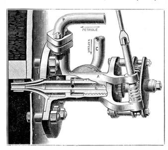
Fig. 2. PETROLEUM INJECTOR.
