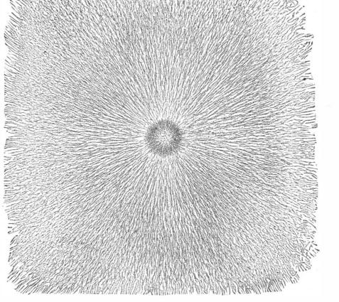
FIG. 25.-ARRANGEMENT OF FILINGS OVER THE END OF A ROUND MAGNET.
