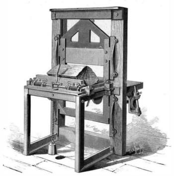
Fig. 2.-TREVOR & CO.'S SHINGLE-CUTTING MACHINE.
