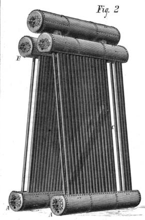
Fig. 2.—THE FIRMENICH SAFETY STEAM BOILER.
